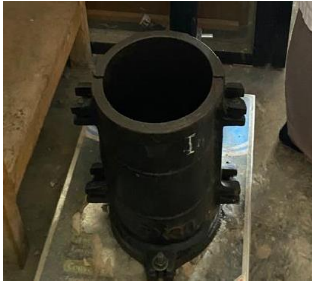
Gambar 9. Cetakan spesimen uji tekan
