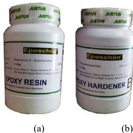
Gambar 14. Perekat komposit laminat Jute: (a) Epoxy, dan (b) pengerasnya
