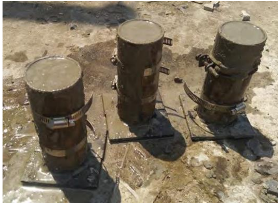
Gambar 19. Agregat beton yang telah dituangkan ke dalam cetakan
